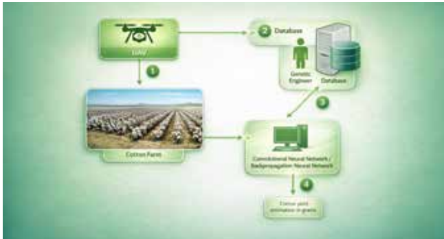
Şekil 1. UAV Tabanlı Görüntüleme ve Derin Öğrenme ile Pamuk Verim Tahmin Süreci (Unluturk et. al., 2024).
